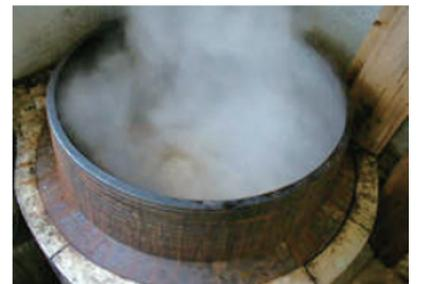
図7. 煮熟を行う釜と高温のアルカリ性水溶液の様子
